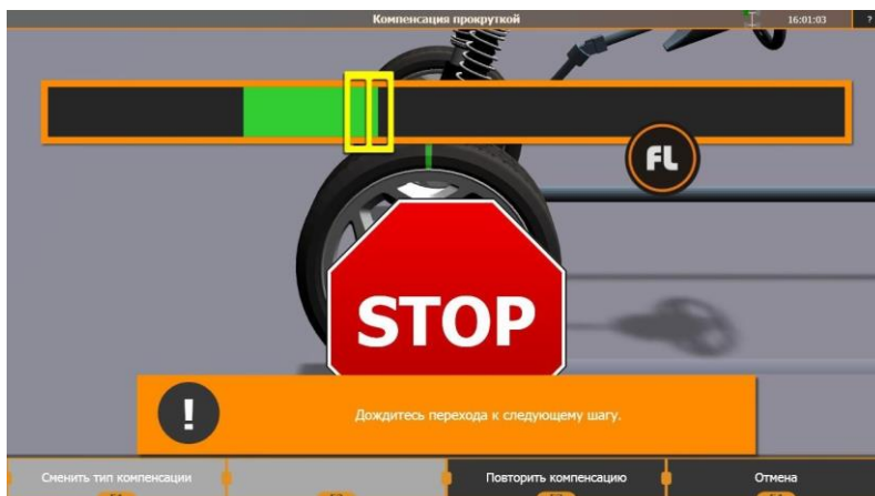
Рисунок 3.25 – Вычисление изначального положения мишени для компенсации
