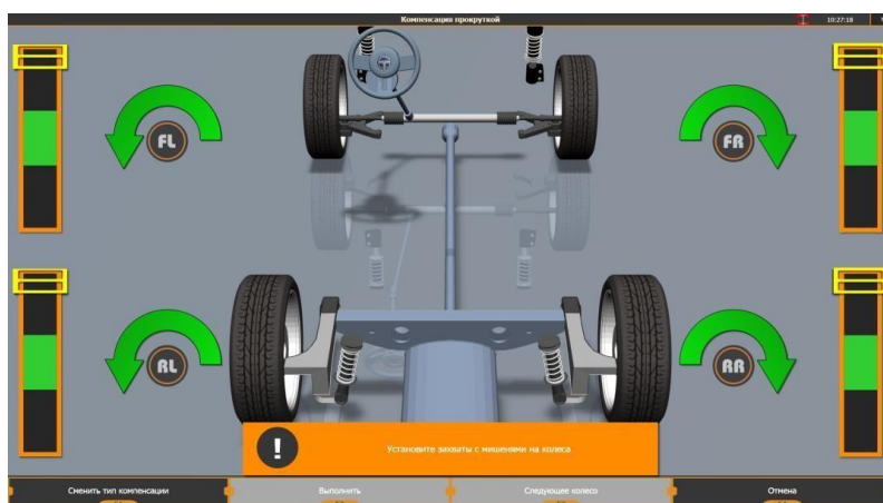
Рисунок 3.24 – Установка мишеней для компенсации прокруткой
